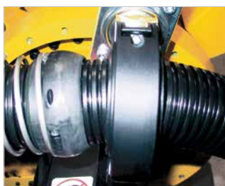
■ Staffa per tubo con semigusci a scorrimento e manicotto anti-abrasione
